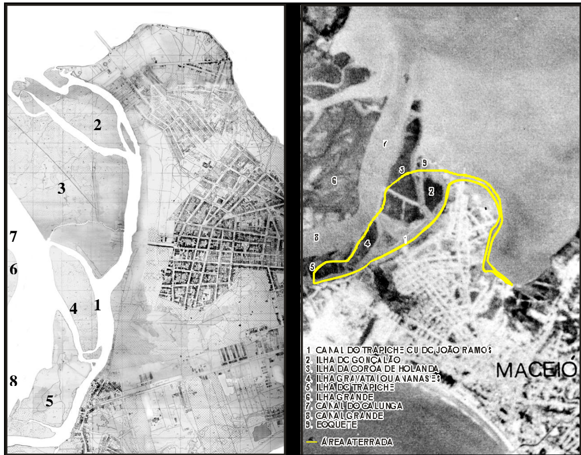
Imagem 24 – Fotomontagem mostrando as ilhas lacustres posteriormente anexadas ao solo urbano de Maceió, bem como o canal aterrado. Imagem 25 – Foto aérea de 1965, com destaque em amarelo mostrando a nova configuração que seria alcançada após os aterros. Em ambas as fotos: 1 – Canal do Trapiche ou do João Ramos; 2 – Ilha do Gonçalo; 3 – Ilha da Coroa de Holanda; 4 – Ilha Gravata ou Ananases; 5 – Ilha do Trapiche; 6 – Ilha Grande; 7 – Canal do Calunga; 8 – Canal Grande; 9 – Boquete.
